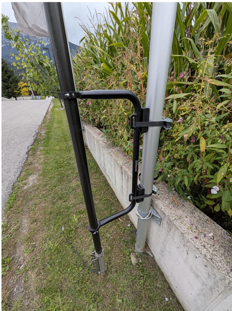
Teleskopmast mit Spanngurten an fester Infrastruktur befestigt.
