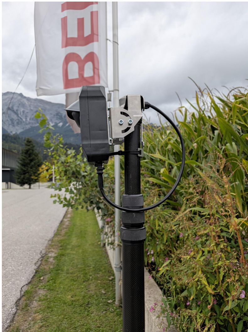
Am Teleskopmast montierter und gesicherter Detektor mit angeschlossenem Stromkabel.
