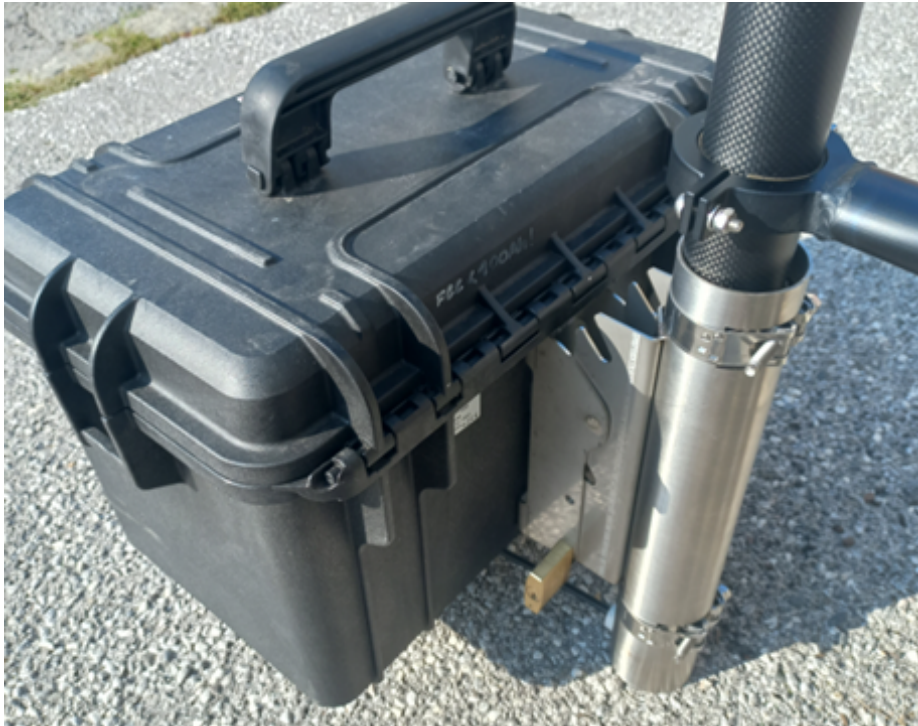
Akku-Box in der Mastführung gesichert.
